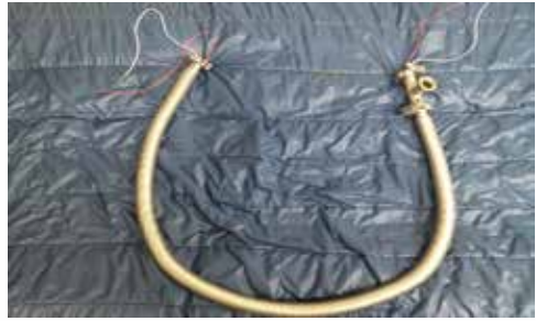
図2. 高Tc超伝導電力ケーブルを用いた送電管
