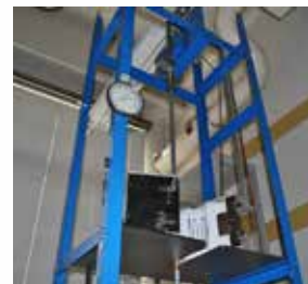
接着エネルギーを測定するための衝撃試験装置
