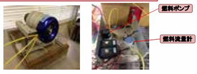
小型ジェットエンジンの燃料供給量を、ステップ状に変えたときのエンジンの動特性試験などを行っている
