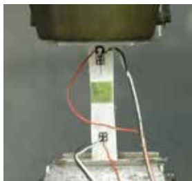
接着剤自体の強度を引張試験機で測定
