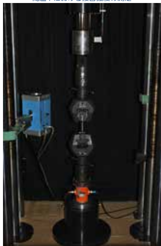
紐手の強度を引張試験機で測定
