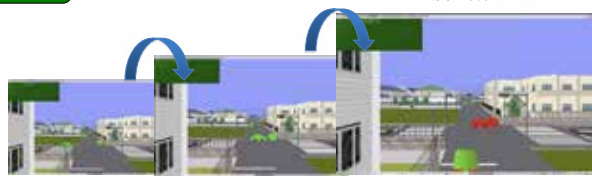
図7 交通事故現象創発のシミュレーション(交差点内での事故発生の様子)
