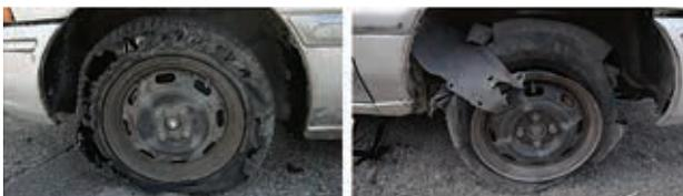
Fig. 13 1回目（前輪左側）と2回目（前輪右側）のタイヤバースト
