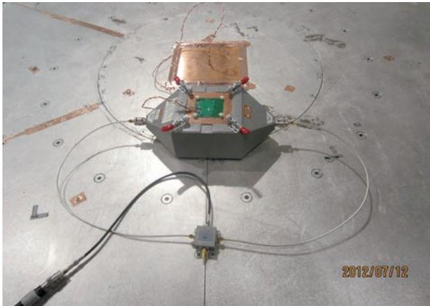
図9 DC-DCコンバータの起電力測定の様子
