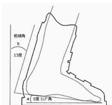
図3 スキーブーツの前傾角とランプ角
